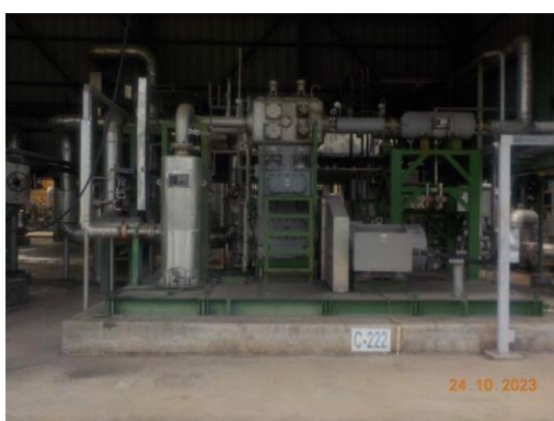
รูปที่ 3.4 Flash Gas Compressor (C-222)
